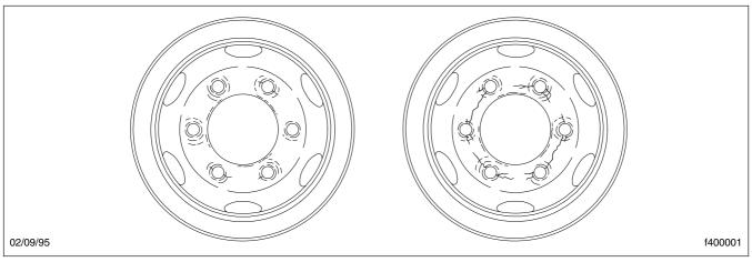
Fig. 15.9, Worn Stud Holes
